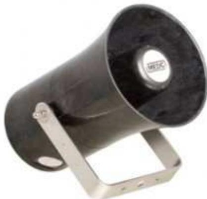
Эти громкоговорители предназначены для использования в потенциально взрывоопасных газовых средах, имеют номинальную мощность до 15 Вт и подходит для использования в газовых группах IIВ плюс водорода и IIС. Взрывонепроницаемая, крышка и корпус, изготовлены из УФ-устойчивого, усиленного стекловолокна полиэстера. Винты из нержавеющей стали и для монтажа включены для защиты от коррозии.
