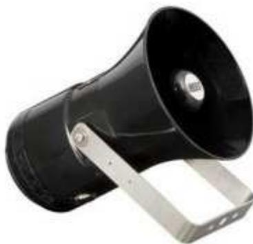
DB4B - имеет высокую взрывозащищенность по мощности и введен в качестве замены для текущего рупора DB4 с улучшенной разборчивостью речи и акустическими характеристиками. Сертификация позволяет использовать его в широком диапазоне температур (от -55°C до + 70 °C) корпус Ex изготовлена из стеклопластика из прочного термопластического материала, который предохраняет от коррозии и имеет эстетичный вид.
