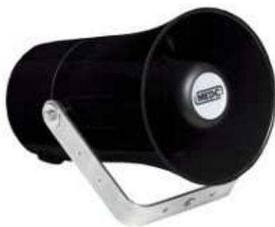
Этот громкоговоритель, предназначенный для использования в Зоне 2, взрывоопасных газов и пылевых сред, имеет номинальную мощность до 15 Вт и подходит для использования во всех группах газа, включая водород.
